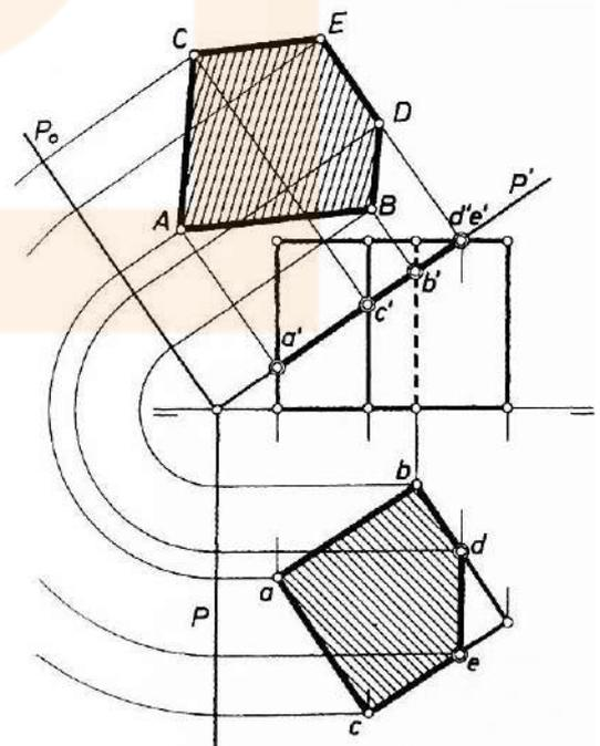
**Sección plana en el hexaedro por un plano oblicuo (mediante cambio de plano):** Aunque se podría realizar determinando la intersección de cada una de las aristas con el plano, lo más fácil (y esto es aplicable a todas las secciones planas) es colocar el plano en posición de plano proyectante mediante un cambio de plano. De esta forma, la sección que produce el plano se verá como una recta, siendo así su determinación inmediata, como vimos en el ejercicio anterior.
