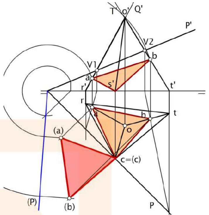
**Mediante cambio de plano:** realizaremos un **cambio de plano vertical**, para convertir el plano oblicuo P en un plano de canto (perpendicular al plano horizontal). Una vez obtenida la nueva proyección vertical de la pirámide, las intersecciones se hallan más fácilmente.
