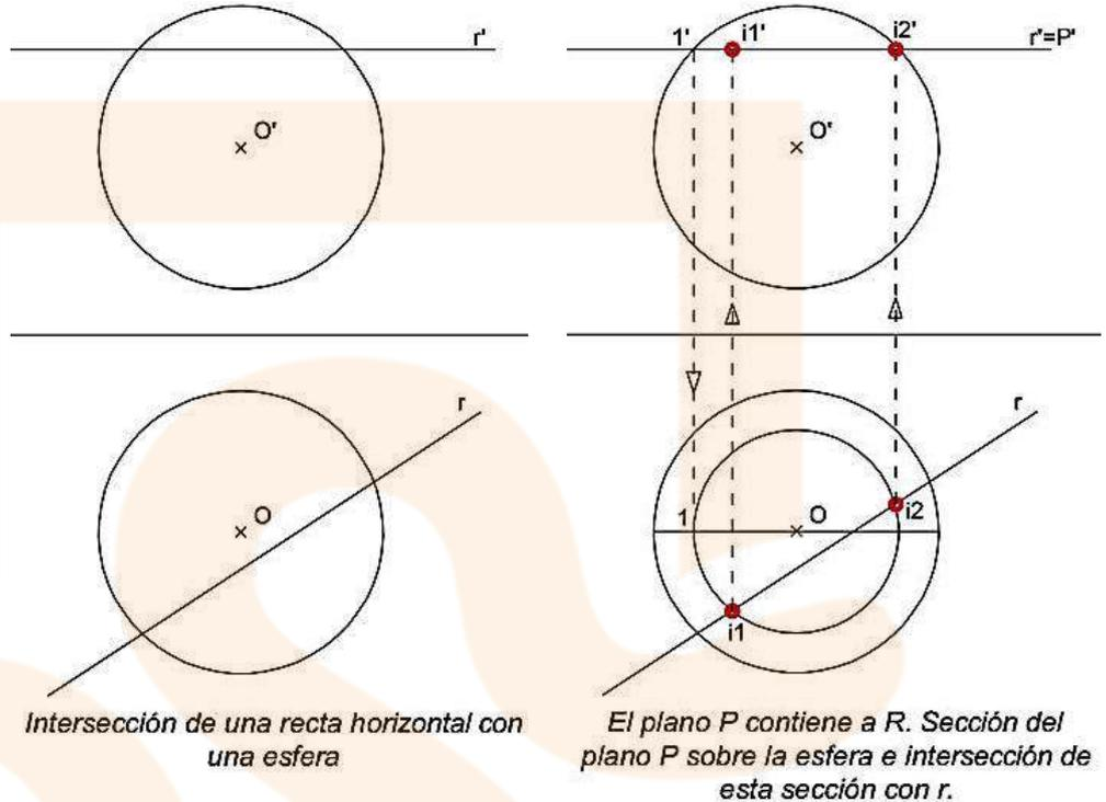
**2.-Si la recta es oblicua. Resolución mediante giro:** Consiste en girar la recta R hasta colocarla como frontal R2. En este momento hacemos la sección que produce un plano P frontal que contiene a R2 sobre la esfera, que será una circunferencia vista en verdadera magnitud. La intersección de esta sección en forma de circunferencia con la proyección vertical r2' de la recta girada nos da los puntos de intersección en el giro.
