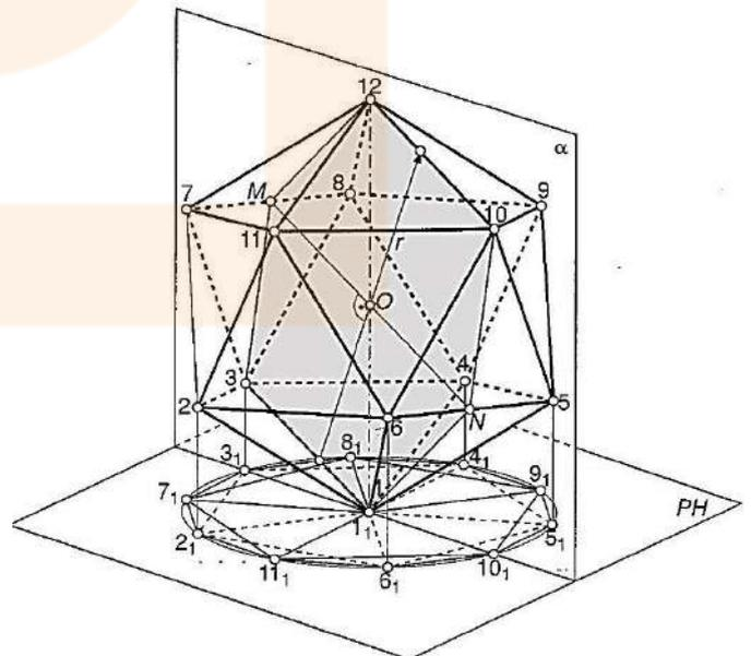
**Sección principal:** seccionamos el icosaedro por un plano que pase por dos aristas opuestas. La sección es un hexágono con dos lados opuestos iguales al valor de la arista dada (1,3 y 10,12) y los otros cuatro iguales a la distancia de un vértice del triángulo a una de las caras.
