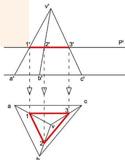
**Sección por plano paralelo a la línea de tierra:** Aparentemente este plano no corta a la pieza ya que ninguna de las trazas corta a las proyecciones del prisma. Pero si llevamos la figura al plano de perfil el plano corta completamente a la pieza.
