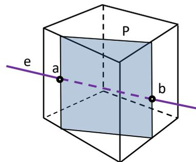
En este caso, el plano auxiliar tomado es proyectante horizontal, paralelo por tanto a las aristas del poliedro. Por ser proyectante horizontal, su traza  $P$  coincide con la proyección horizontal  $r$  de la recta. Los puntos de corte definidos en esa traza horizontal se refieren sobre la proyección vertical  $r'$ , determinando la intersección buscada.
