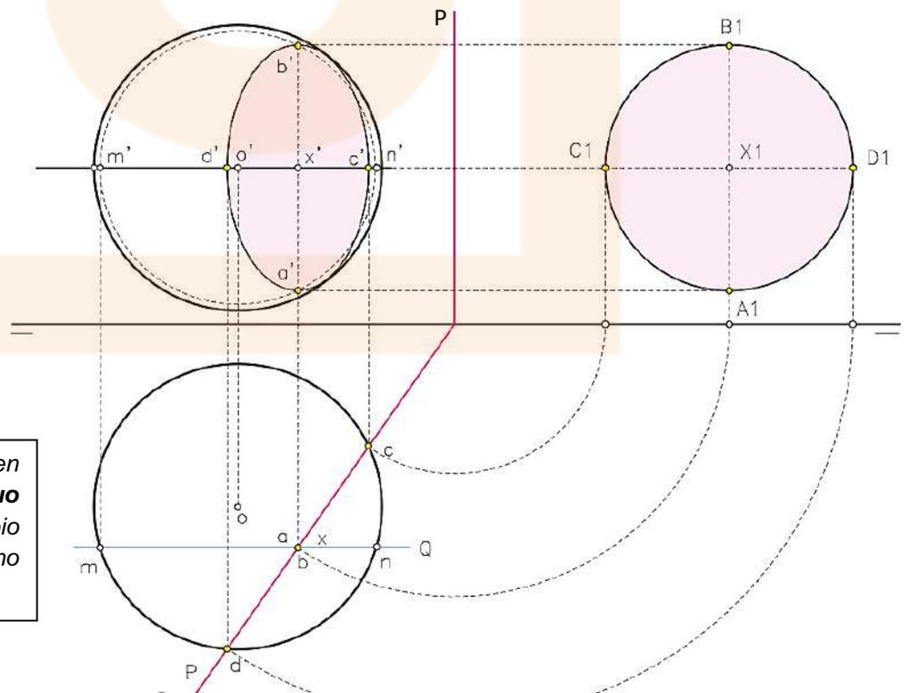
Para calcular la sección generada en la esfera por un **plano oblicuo** cualquiera realizaremos un cambio de plano hasta convertir el plano secante dado en proyectante.
