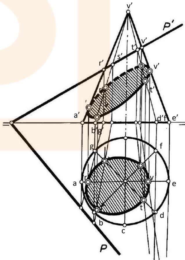
**Mediante cambio de plano:** realizaremos un cambio de plano hasta convertir al plano oblicuo en proyectante. La sección se aprecia así directamente sobre las nuevas proyecciones verticales del cono. La curva resultante es una **elipse**.
