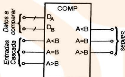
El símbolo genérico que podemos asociar a un comparador sería el indicado, donde en las entradas introducimos  $D_A$  y  $D_B$ , que son los datos a comparar. Las *entradas* en cascada, indicadas por  $A < B$ ,  $A = B$  y  $A > B$ , se utilizan para introducir la información proveniente de otro comparador, de forma que se puedan comparar datos de un número cualquiera de bits.
