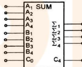
En la figura de la derecha aparece el símbolo de un sumador de dos datos de cuatro bits.
