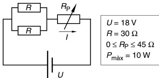
L'esquema de la figura representa un circuit elèctric de resistència variable. Les dues resistències tenen el mateix valor  $R = 30 \Omega$ , el potenciòmetre pot variar la seva resistència entre  $0 \Omega$  i  $45 \Omega$ , i la tensió d'alimentació és  $U = 18 \text{ V}$ .
