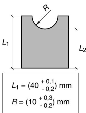
En un plàtol d'una peça s'han acotat  $L_1$  i  $R$  tal com s'indica en la figura. La distància  $L_2$  és:
