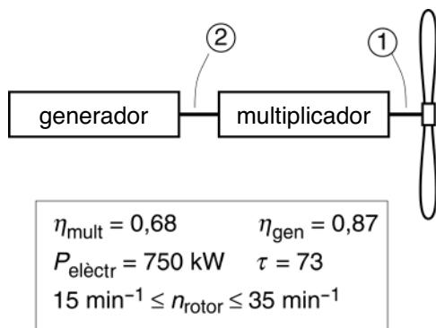
Un aerogenerador consta, bàsicament, d'un rotor amb pales, d'un multiplicador de la velocitat de gir i d'un generador. Considerem que el rendiment del multiplicador,  $\eta_{\text{mult}}$ , i el del generador,  $\eta_{\text{gen}}$ , són constants.
