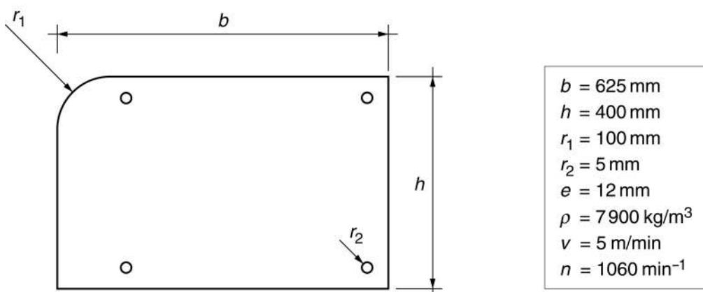
La peça de la figura s'ha obtingut a partir d'una planxa d'acer inoxidable de gruix  $e = 12 \text{ mm}$  i densitat  $\rho = 7900 \text{ kg/m}^3$ . El tall s'ha fet, amb una màquina de tall per doll d'aigua, a una velocitat  $v = 5 \text{ m/min}$  i els quatre forats de radi  $r_2$ , amb un treplant que gira a  $n = 1060 \text{ min}^{-1}$ . Determineu:
