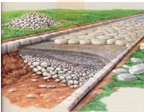
7.16 Dibuix i secció d'una calçada romana, on s'aprecien totes les seves parts
