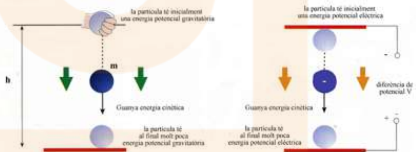
Figura 5. La figura mostra com en el cas d'una massa (esquerra) o d'un electró (dreta), hi ha un guany d'energia cinètica = pèrdua d'energia potencial (Font Advancing Physics A2 , IOP)
