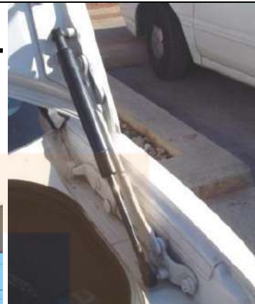
Exemple de mecanisme de 4 barres amb amortidor.
