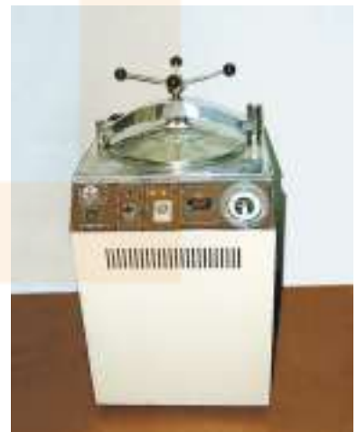
Una autoclau és un aparell utilitzat per a l'esterilització, mitjançant un sistema de pressió de vapor. Assoleix temperatures superiors als 100 °C, que es mantenen durant 20 o 30 minuts, per a la correcta esterilització d'estrís i recipients. S'utilitza en la indústria, en laboratoris d'investigació i per a l'esterilització de material sanitari.
