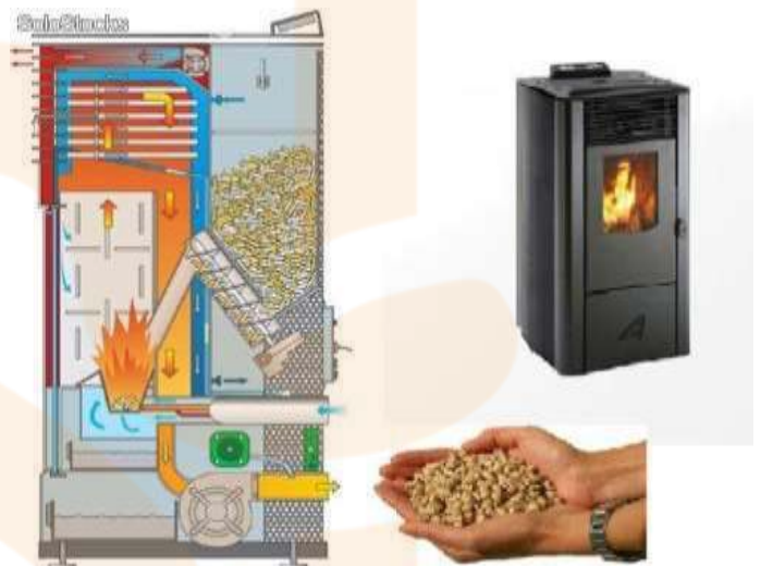
Estufa que funciona amb pel·lets de biomassa.
