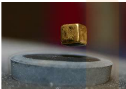
Figura 7. Imant levitant sobre un imant superconductor que es troba a uns -200^{\circ}\text{C} (Peter nussbaumer [CC-BY-SA-3.0], via Wikimedia Commons)
