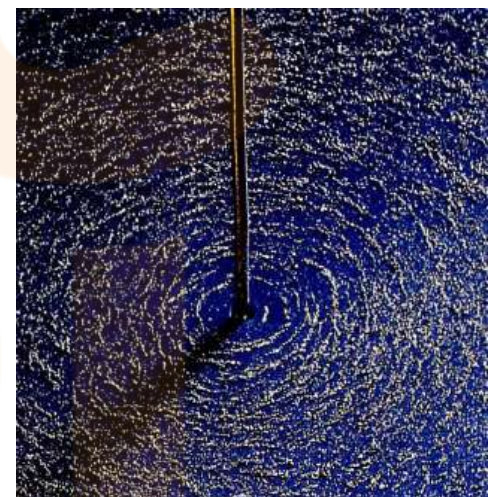
Figura 9. Visualització amb llimadures de ferro del camp magnètic creat per un fil conductor (Font Tipler)
