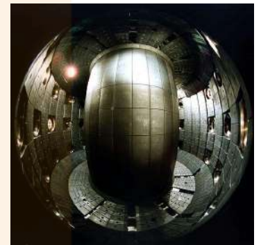
Figura 14. Interior d'un prototipus de reactor nuclear de fusió (Font CRPP-EPFL [CC-BY-SA-2.5], via Wikimedia Commons)
