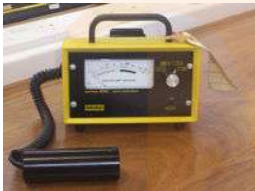
Figura 8. Un comptador Geiger-Müller és un detector de partícules que mesura la radiació ionitzant (Font Boffy b [CC-BY-SA-3.0], via Wikimedia Commons)
