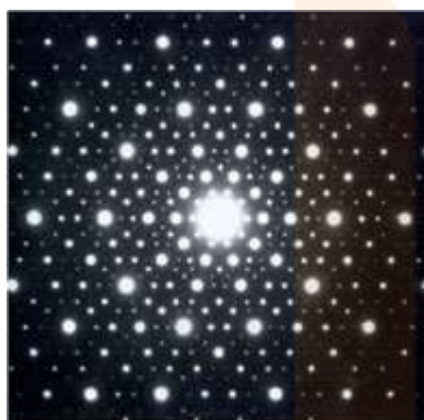
Figura 21. Patró de difracció dels electrons d'una superfície de grafit on es mostra com s'ordenen els àtoms de carboni (Font MaterialsScientist [CC-BY-SA-3.0], via Wikimedia Commons)
